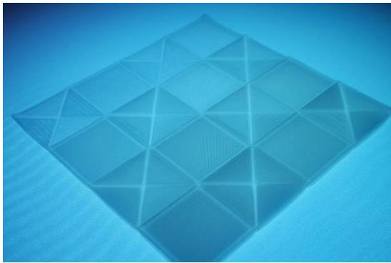
3D-gedrucktes Probebauteil: Die sogenannte Transmissivität, also die Lichtdurchlässigkeit, variiert je nach Schichtdicke und Schichtausrichtung. (Foto: LZH)
