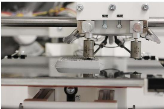
Fused Deposition Modeling (FDM): Bei diesem 3D-Druck-Verfahren werden Kunststoffbauteile Schicht für Schicht aufgebaut. (Foto: IPH)
