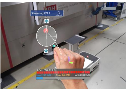
Blick durch die AR-Brille: Der Screenshot zeigt die Benutzeroberfläche für die Gestensteuerung. Logistikmitarbeiter müssen lediglich den roten Punkt greifen, der als virtueller Joystick dient – schon können sie das Fahrzeug bewegen. (Foto: IPH, Florian Kreuzjans)
