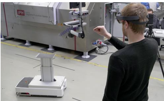
Steuerung über Gesten: IPH-Mitarbeiter Viktor Schell bewegt das Fahrerlose Transportfahrzeug mit einem virtuellen Joystick, der ihm über die AR-Brille eingeblendet wird. (Foto: IPH, Beatrix Kamlage)
