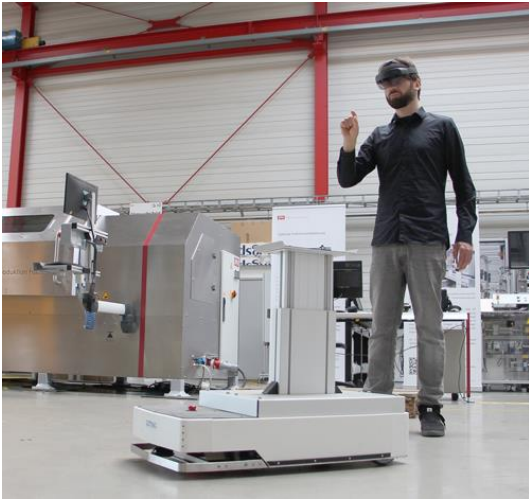
Intuitive Mensch-Maschine-Interaktion: MobiMMI-Entwickler Florian Kreuzjans zeigt, wie die Steuerung per AR-Brille funktioniert. (Foto: IPH, Susann Reichert)
