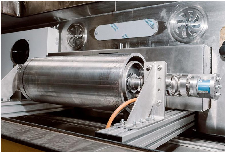
Auch angetriebene Tragrollen lassen sich auf dem neuen Prüfstand testen. (Foto: Niklas Viola, IPH)
