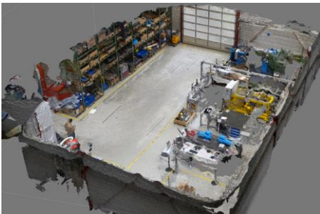
3D-Layout: Aus Drohnen-Fotos ist dieses dreidimensionale Groblayout der IPH-Versuchshalle entstanden. (Quelle: IPH)
