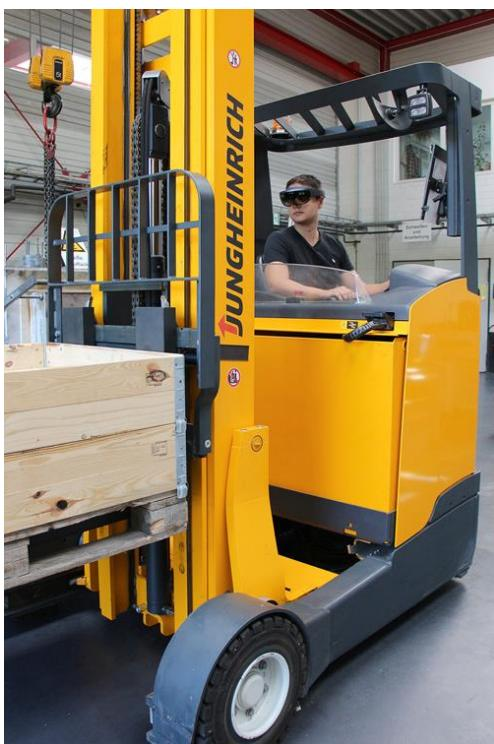
Herausforderung: Am Steuer eines Staplers versperren Hubmast und Ladung die Sicht. (Quelle: IPH)
