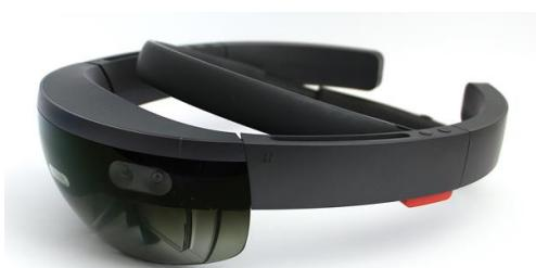
Lösungsansatz: Eine AR-Brille für den Fahrer sowie Kameras am Gabelstapler sollen für einen uneingeschränkten Rundumblick sorgen. (Quelle: IPH)
