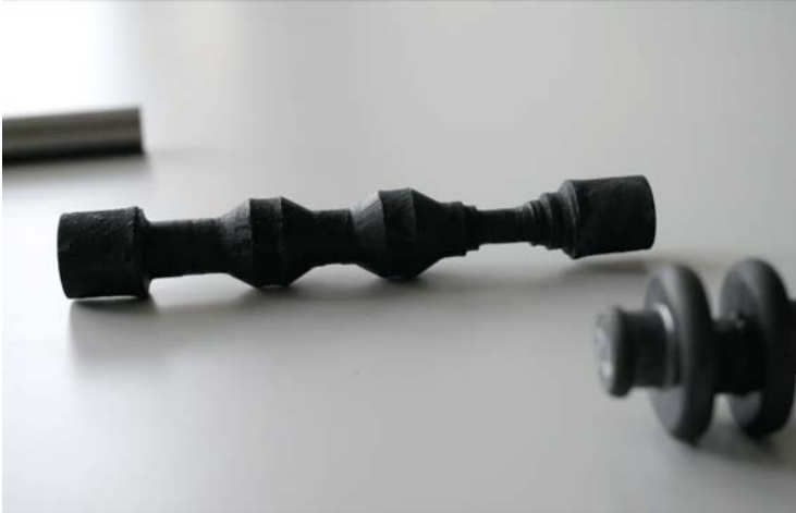
Stadienplanung: In drei Schritten vom Halbzeug zur Kurbelwelle. (Quelle: IPH/Philipp Cartier)
