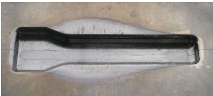
Detailaufnahme der Gesenkgravur: Um verschiedene DLC-Schichttypen zu untersuchen, nutzen die Forscher wechselbare Einsätze. (Foto: IPH)
