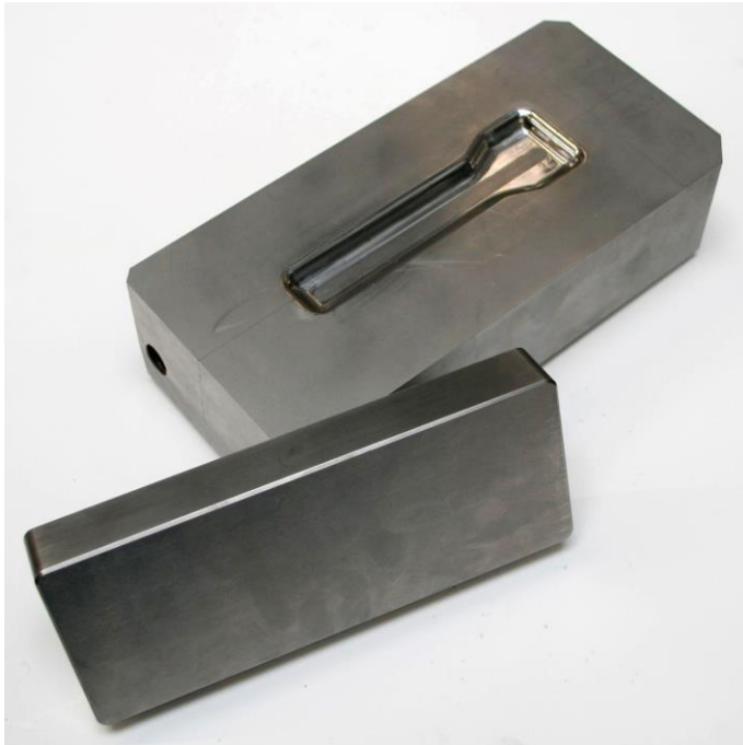
Schmiedegesenk aus dem Forschungsprojekt: Diamond-Like-Carbon-Schichten (DLC-Schichten) sollen vor Verschleiß schützen. (Foto: IPH)
