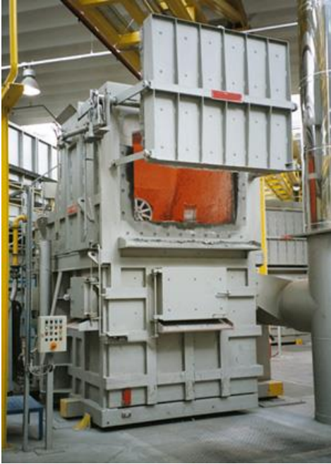
Aluminiumschmelzofen der ZPF GmbH: Eine 3D-Kamera soll künftig den Zustand des Ofeninnenraums überwachen. Darin herrschen bis zu 1000 Grad Celsius. (Quelle: ZPF GmbH)
