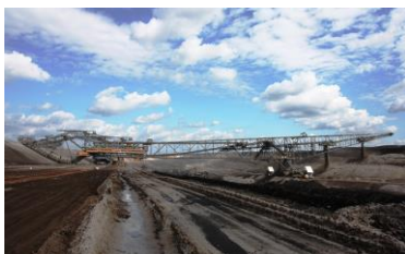
Die Abraumförderbrücke F 60 im Braunkohletagebau Nochten. (Quelle: TAKRAF GmbH)
