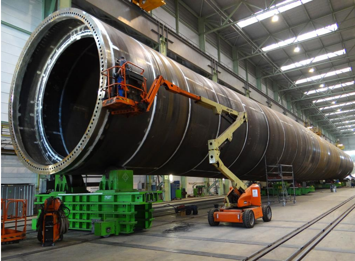
XXL-Produkte: Rohre aus armdicken Stahlblechen fertigt die EEW Special Pipe Constructions GmbH in Rostock. (Foto: EEW SPC)
