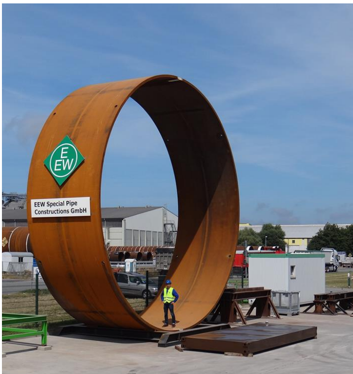
Bis zu 10 Meter Durchmesser: Die XXL-Rohre dienen als derzeit kostengünstigste Fundamentstruktur für Offshore-Windparks. (Foto: EEW SPC)
