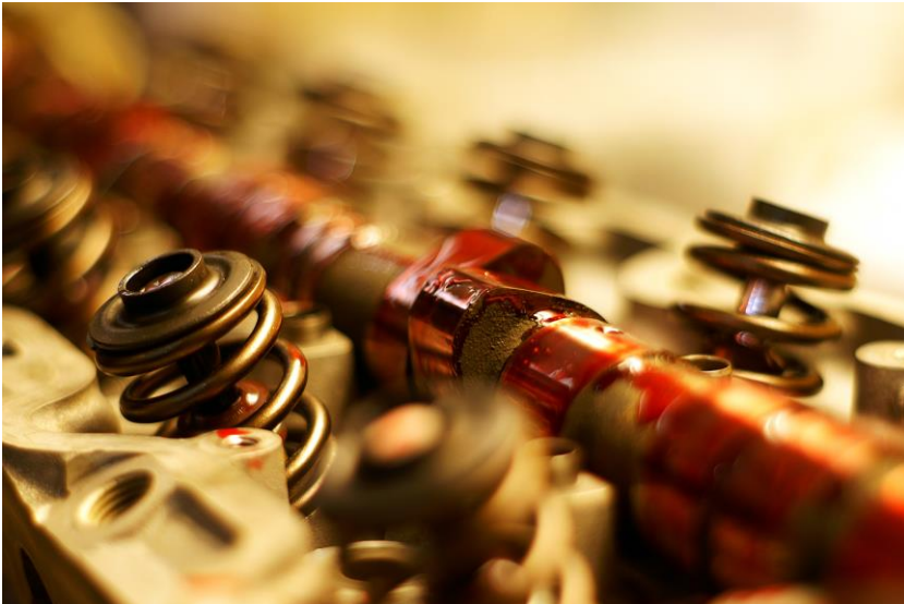
Nockenwelle im Motor: Forscher aus Hannover wollen erstmals berührungslos ihre Position und ihr Drehmoment messen. (Foto: Alexander Lindquist / Creative Commons)
