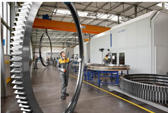
Großwälzlagerfertigung bei Liebherr: Neben solchen Bauteilen wirkt der Mensch klein. (Foto: Liebherr)
