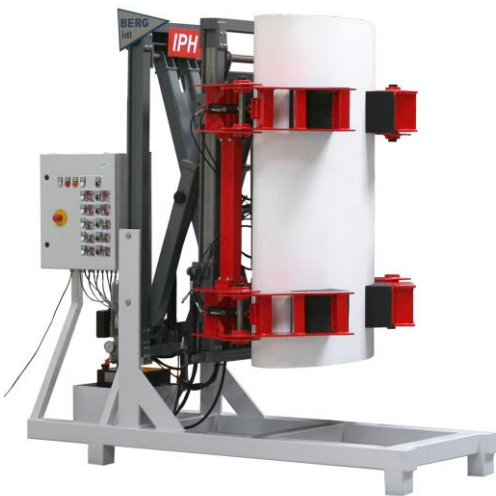
Beim Arbeitskreistreffen zu sehen: Ein Greifer, der die Montage von Rotorblättern erleichtert. (Quelle: IPH)
