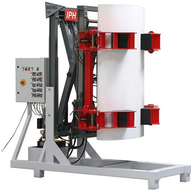
Bei der Hannover Messe zu sehen: Der Rotorblatt-Greifer im Maßstab 1:5.
