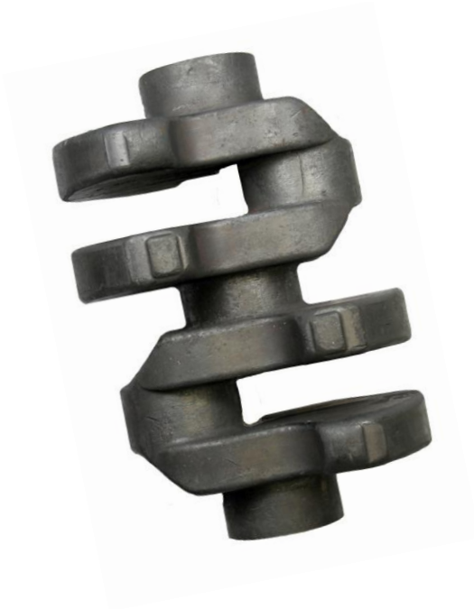
Bild 1: Zweizylinderkurbelwellen wie diese kommen zum Beispiel in Autos und Motorrädern zum Einsatz. Ingenieure des IPH erforschen, wie der Herstellprozess ressourcenschonender werden kann. (Quelle: IPH)
