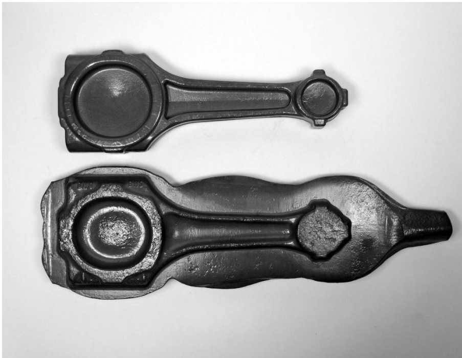
Bild 1: Ohne und mit Grat geschmiedetes Pleuel – Dank der gesteuerten Gratbahn soll das Schmieden zukünftig auch bei weniger Materialeinsatz nicht gleich zur Gratwanderung werden. (Quelle: IPH)
