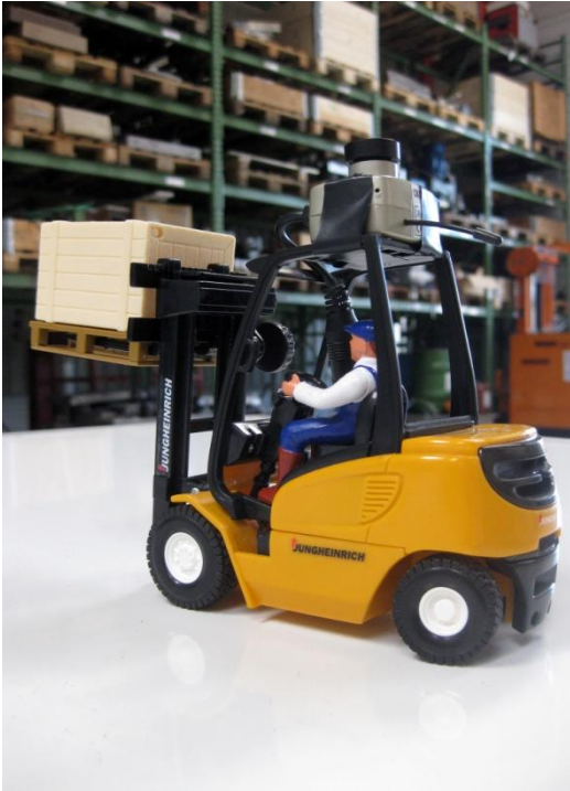
Bild 2: Wo bin ich? Optische Positionsbestimmung im Lager (Quelle: IPH)
