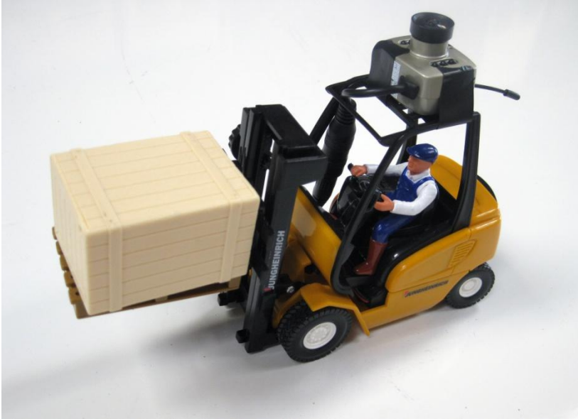
Bild 3: Miniatur-Gabelstapler mit Kamera (Quelle: IPH)
