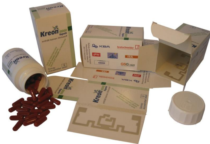
Bild 2: Mehr Sicherheit für Verbraucher: Medikamentenschachteln mit RFID-Tags (Quelle: IPH)
