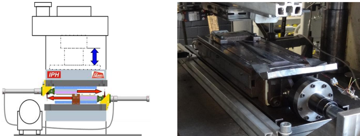
Bild 6: Querkeilwalz-Modul mit Flachbacken für hydraulische Pressen (links: Einbaukonzept, rechts: Beispielmodul)
