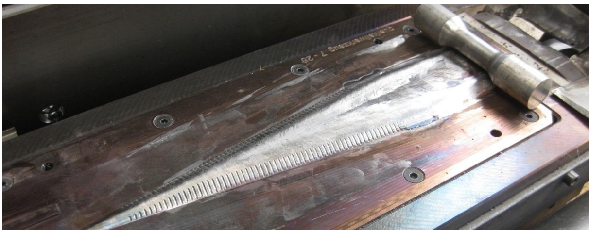
Bild 11: Adhäsion von Aluminium auf dem Walzkeil
