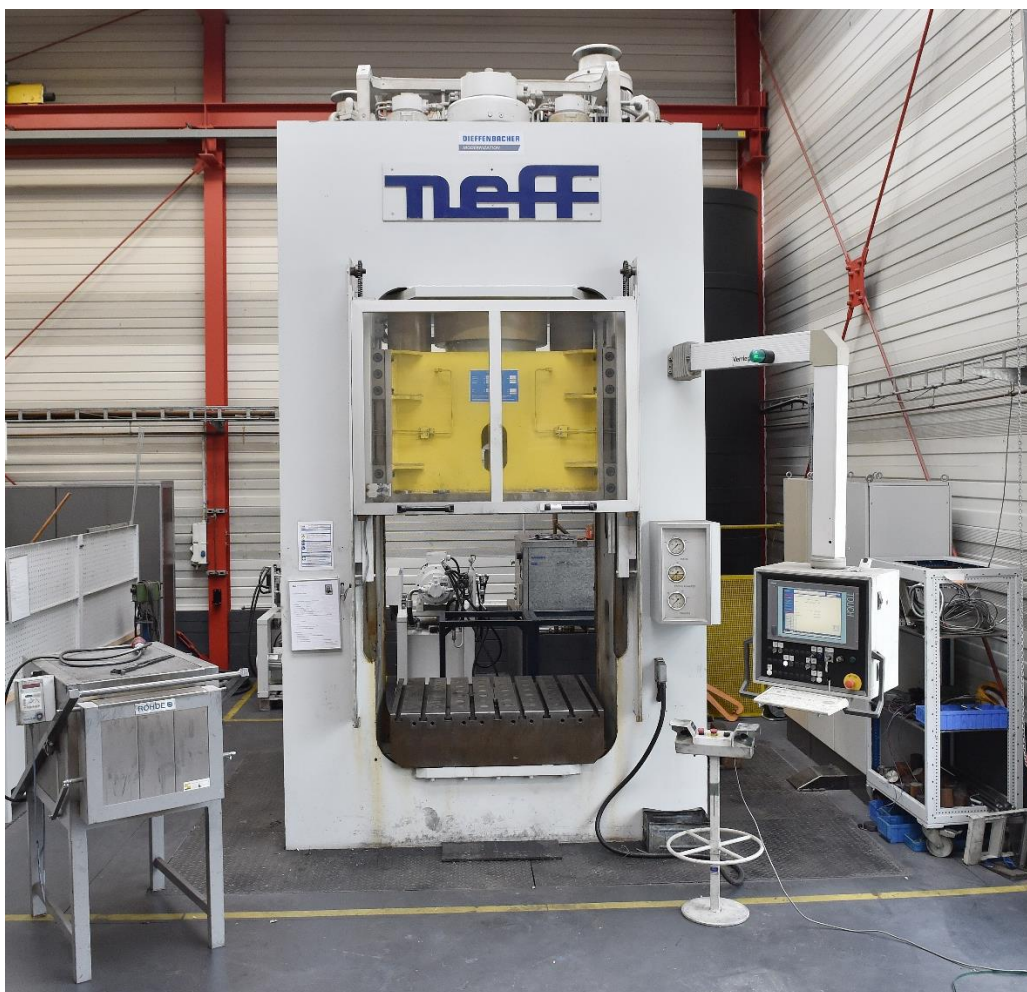
Bild 3: Hydraulische Presse, in die ein IHU-Werkzeug eingebaut werden kann (Bildquelle: IPH)
