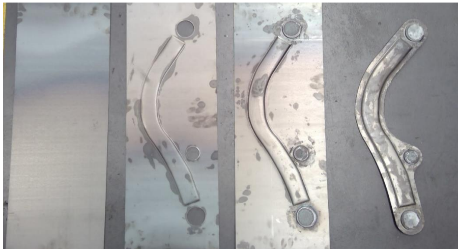
Bild 2: Ergebnis des Folgeverbundhybridschmiedeprozesses am IPH mit Chronologie von links nach rechts
