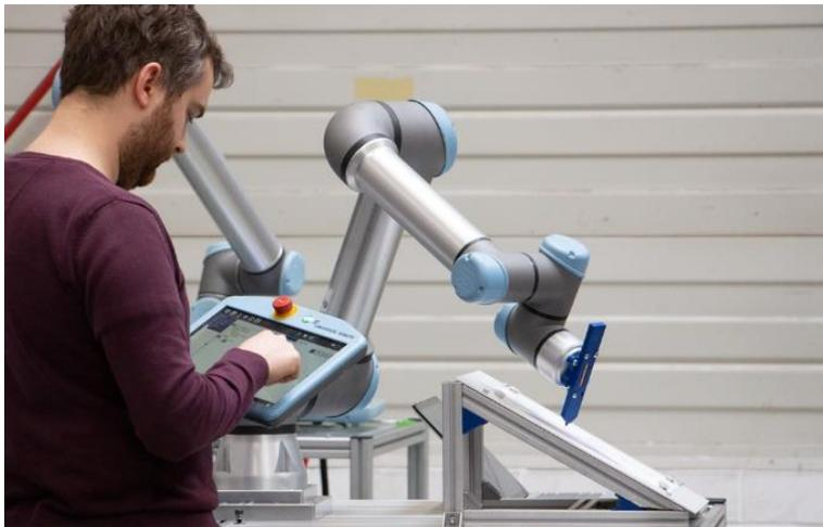
Cobots sind kollaborierende Roboter, die direkt mit Menschen zusammenarbeiten können, um sie zu unterstützen. (Foto: Susann Reichert / IPH gGmbH)
